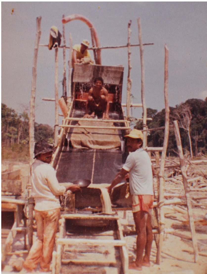
Figura 20: Despescagem da caixa/“lontona”, uma das fases finais para obtenção do ouro.
