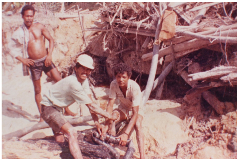
Figura 18: Paulo Afonso e parceiros de trabalho consertando mangueira de absorção do cascalho de ouro.
