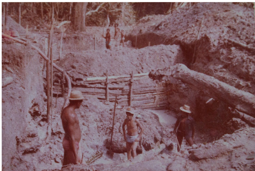
Figura 16: Garimpeiros escavando barranco manualmente. Garimpo São Domingos.
