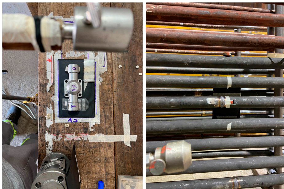
Figuras 12 e 13: Preparo de serviço de gamagrafia usando fonte Iridio-192.
