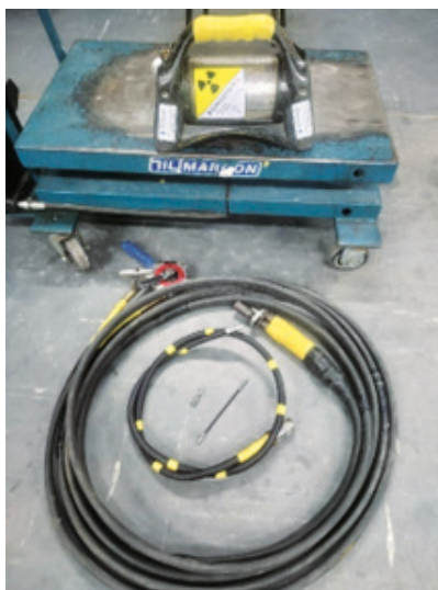
Figuras 21, 22, 23 e 24: Componentes de um equipamento de gamagrafia.
