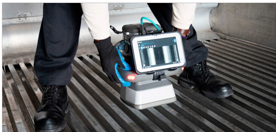
Figura 36: Equipamento portátil de raios X para inspeção por transmissão
