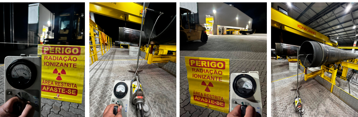
Figura 1: Composição sobre a preparação de ensaio radiográfico com raios gama (gamagrafia).
