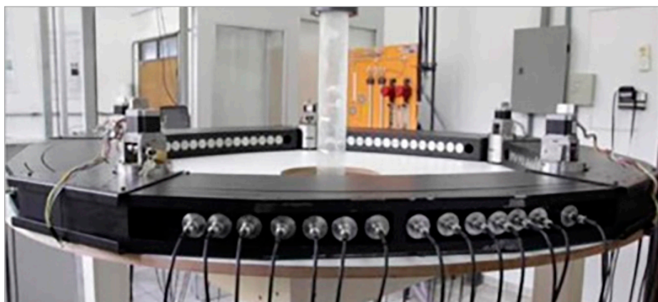
Figura 28: Imagem do tomógrafo Instant Non-Scanning com a coluna de bolhas dinâmicas.
