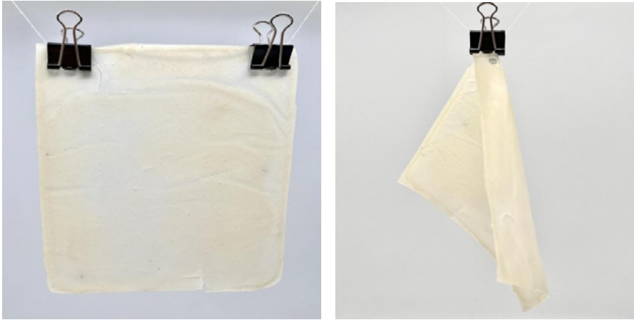
Figura 1: Biomaterial a partir de tapioca e cera de carnaúba
