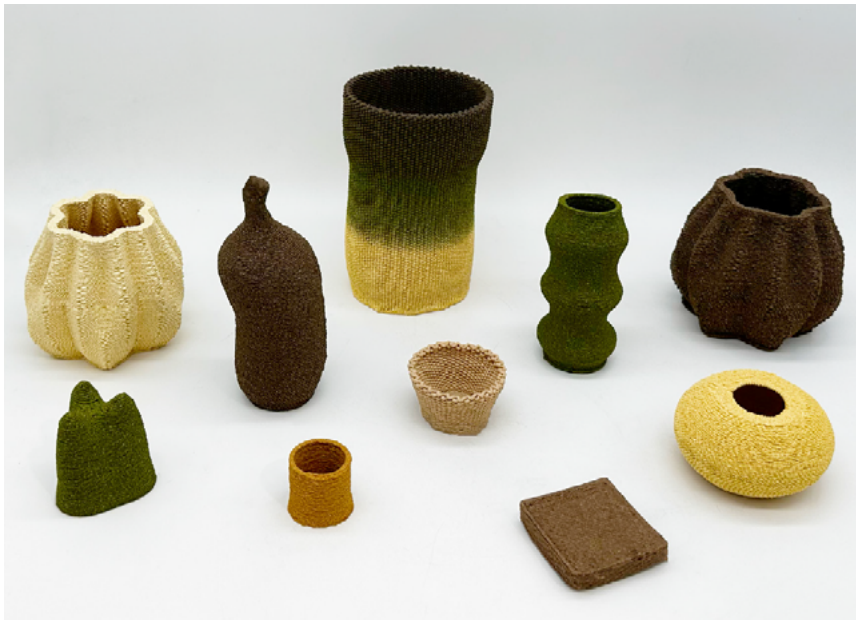
Figura 2: Peças em biomateriais de fabricação pessoal impressas em 3D por extrusão de pasta
